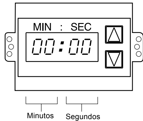
Figura 3-3. Control digital de velocidad del transportador
