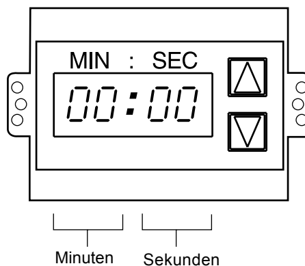
Abbildung 3-3. Digitale Steuerung der Fördergeschwindigkeit
